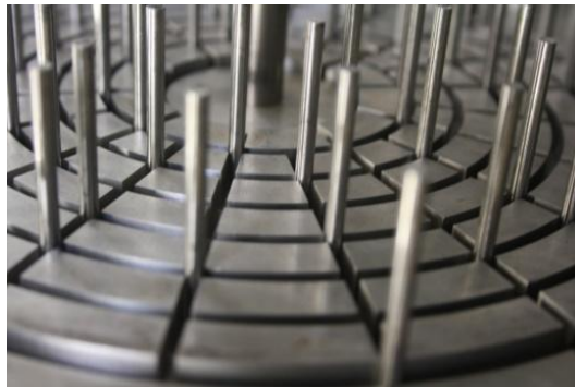
Detailansicht einer Form mit langen, dünnen Auswerfern.
